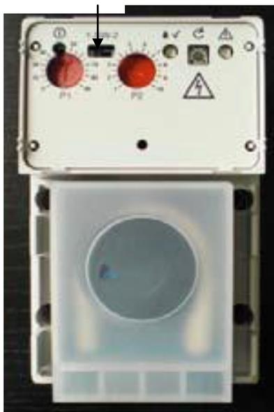
Макс. производительность настраивается потенциометрами. Левый потенциометр P1 предназначен для грубой настройки (0- 20- ... 100 об./мин.). Правый потенциометр предназначен для тонкой настройки (0-10 об./мин.). При настройке следить за положением ползункового переключателя.
