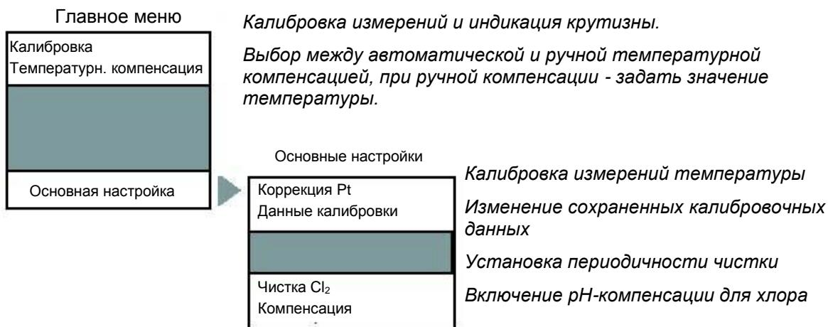
Для измерения сначала следует откалибровать измерения хлора и pH. В случае pH это производится с помощью двух буферных растворов с известной величиной pH. В случае измерения хлора достаточно одноточечной калибровки:
