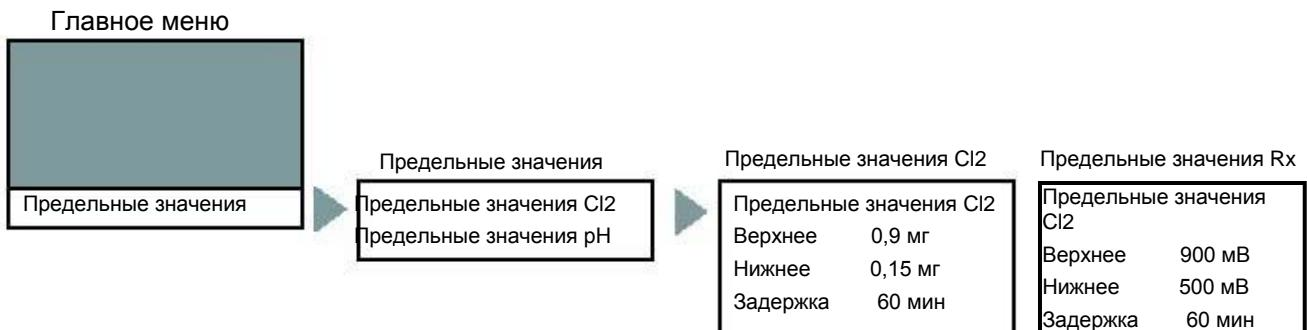
Для измерения хлора (Redox) и для измерения pH можно установить верхнее и нижнее предельные значения.
