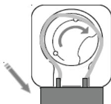
Вставьте новый шланг держателем в нижнюю часть корпуса насоса. Вращая вручную ротор по часовой стрелке, пропустите вокруг него шланг.
