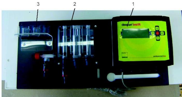
Исполнение с измерительной ячейкой
