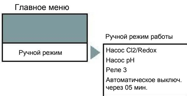
Регулятор Хлор и Recox предназначен для первого насоса, а регулятор pH - для второго.
