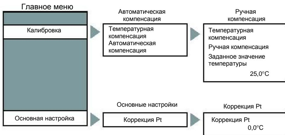
Возможен выбор между двумя видами температурной компенсации:
